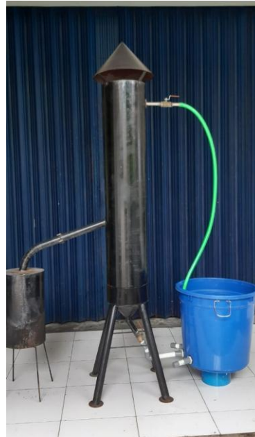
Gambar 1. Cerobong model Wet Scrubber yang digunakan dalam penelitian.
